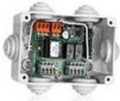
Conexión en línea bus, para realizar centralizaciones. A través de este módulo podemos realizar centralizaciones línea bus, además, nos permite el accionamiento vía radio de la tarjeta a través de todos los sistemas de mando a distancia de Cherubini.
