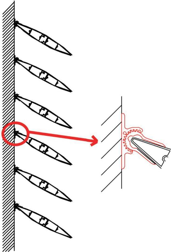
Con la utilización de los accesorios de clipaje se pueden confeccionar MUROS CORTINA empleando las lamas OVALADAS 120-210-300 así como dar diferentes inclinaciones y separación según convenga.
